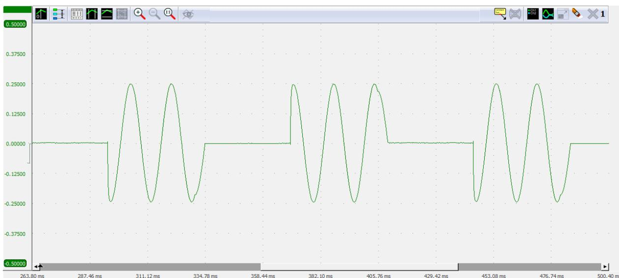
Cada SCR/tiristor es un interruptor que puede proporcionar una onda completa de corriente alterna o conducciones de ángulo de fase proporcional para potencia eléctrica. El AKGrad32 realiza una regulación de potencia equilibrada con una alta precisión para su proceso de calentamiento. A su vez, garantiza una vida límite óptima de los elementos térmicos de acuerdo a distintos fabricantes de dicho tipo de elementos.
