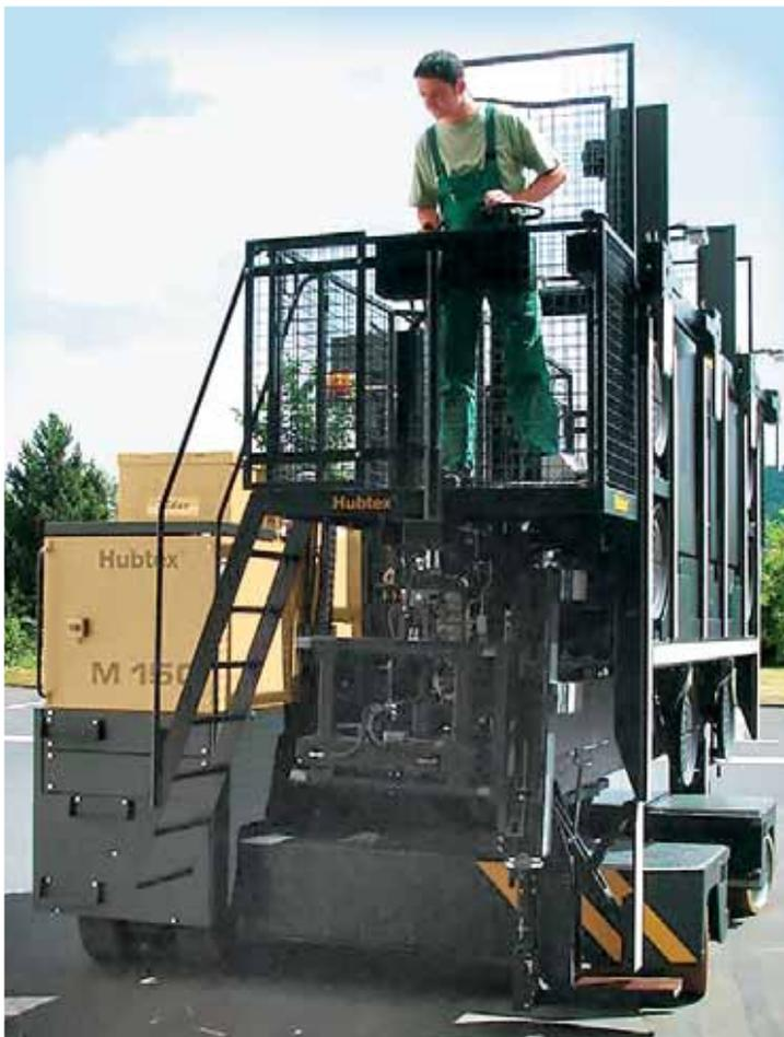
Zwei zusätzliche seitliche Bedienpulte jeweils stirnseitig für bessere Sicht in Fahrtrichtung und zum besseren Positionieren der Seitenpratzen.
